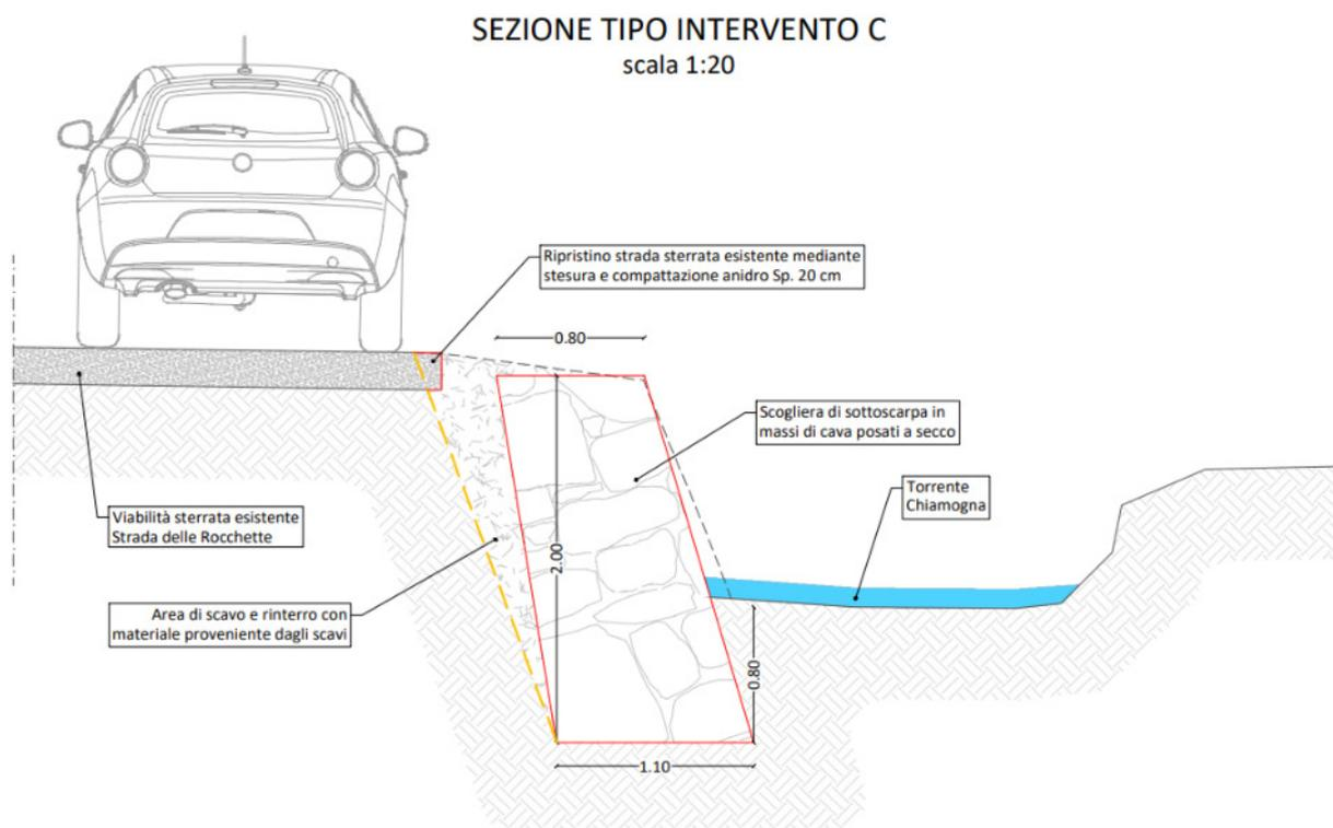
Figura 10. Sezione tipo intervento C.
