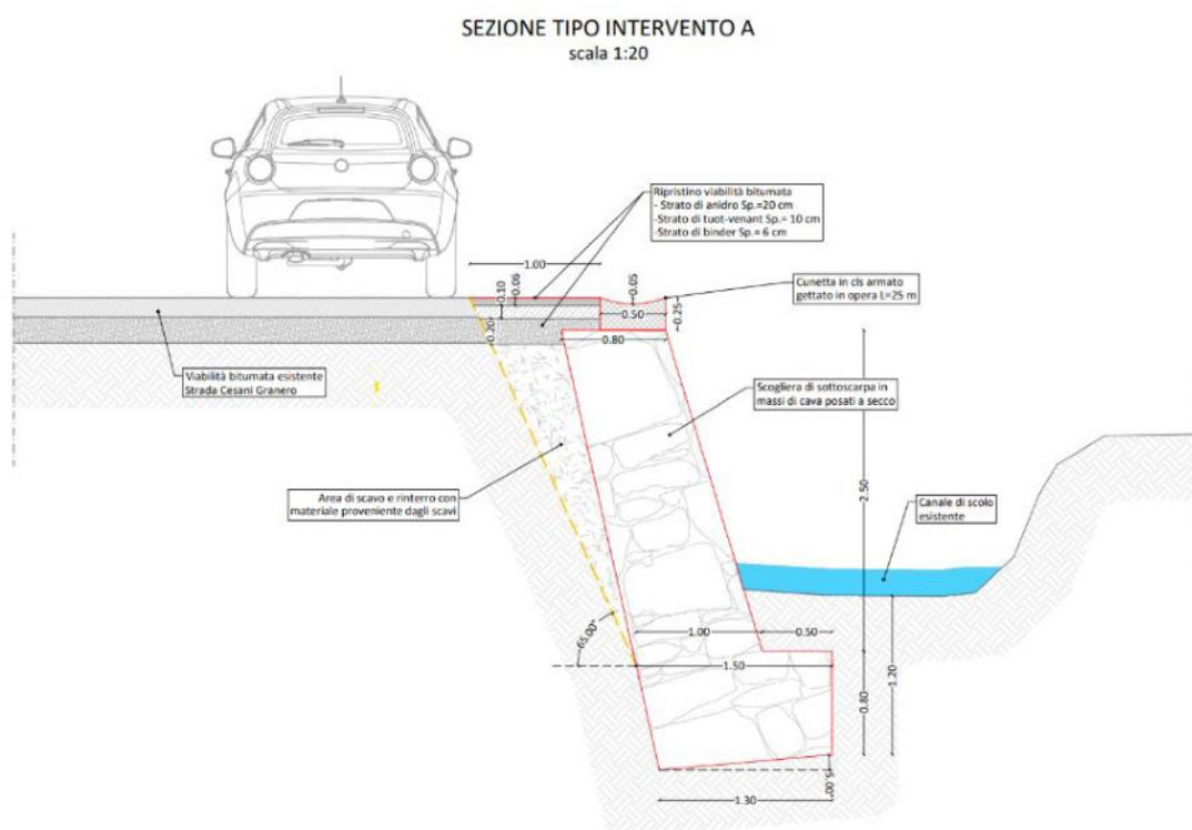
Figura 8. Sezione tipo intervento A.
