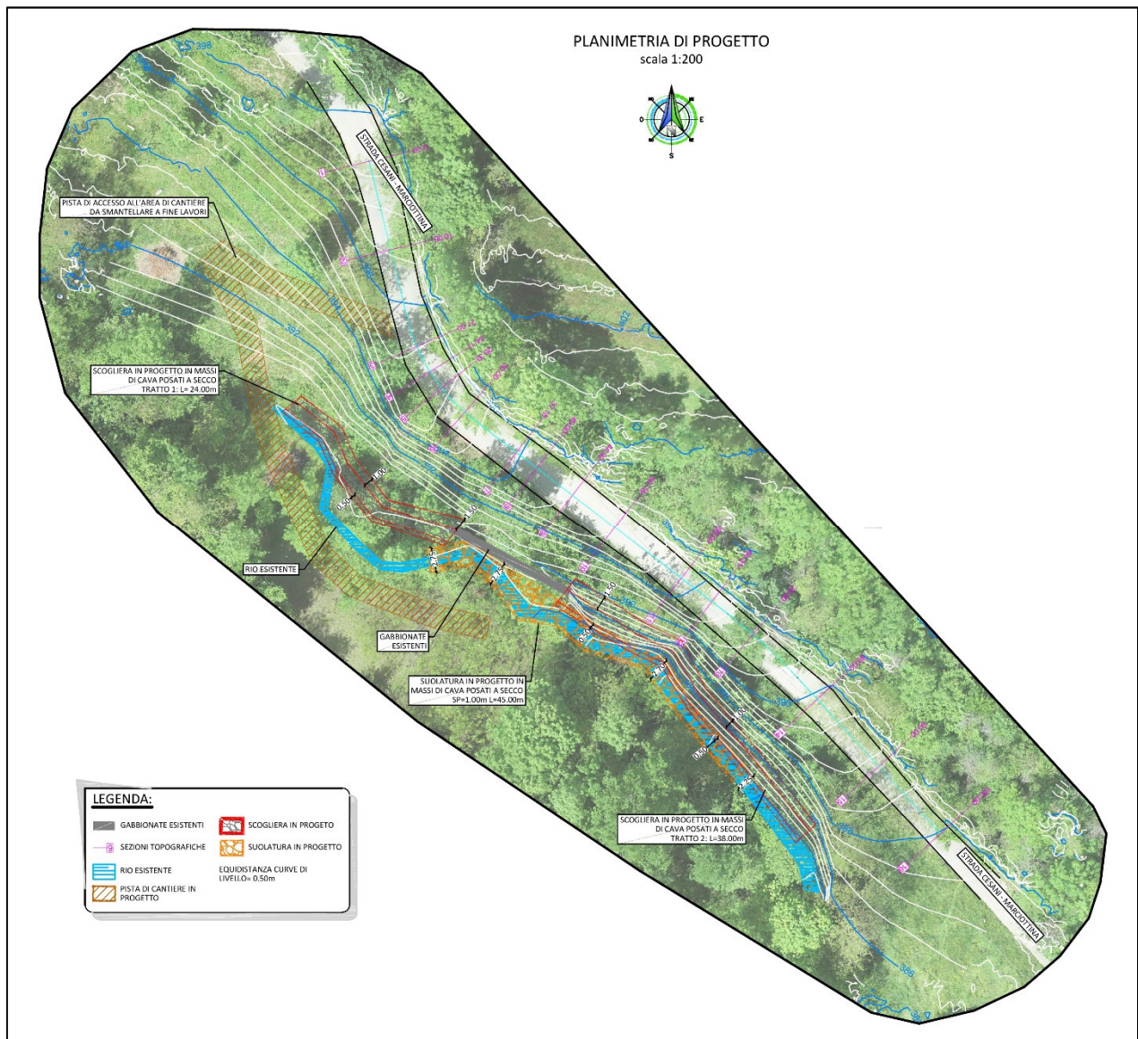
Figura 9 – Estratto della Tav.03_Planimetria_progetto – planimetria di progetto – scala 1:200
