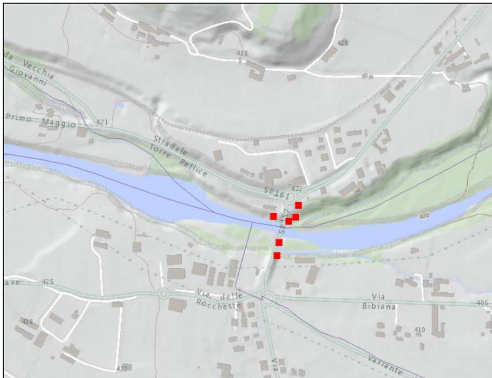
**Figura 4 – Ubicazione delle indagini geognostiche (quadrantini rossi) eseguite negli anni 1977-1978 in corrispondenza del ponte della S.P. 157 (fonte ARPA Piemonte). Non in scala.**
