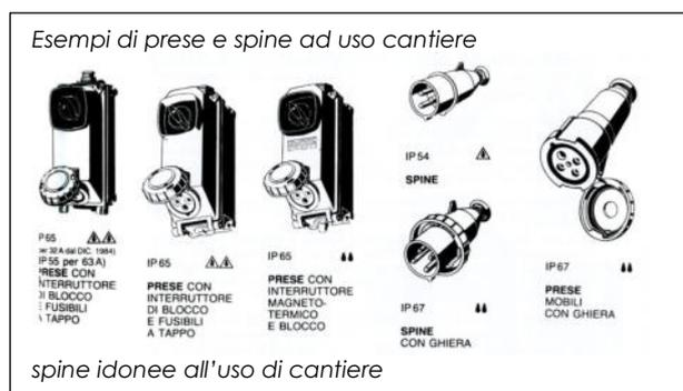
Si ricorda, inoltre, l'assoluto divieto di connessione agli apparecchi utilizzatori con altri sistemi diversi dalla presa a spina o dalle morsettiere con serraggio a vite (tipo antitranciamento).
