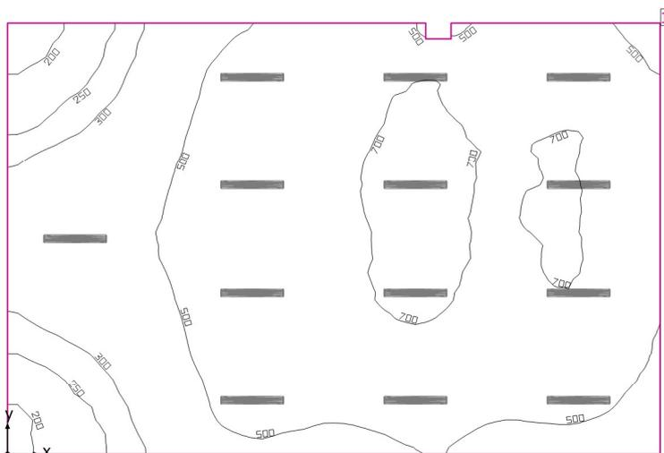
Altezza libera: 3.000 m, Coefficienti di riflessione: Soffitto 70.0%, Pareti 78.9%, Pavimento 20.0%, Fattore di diminuzione: 0.80
